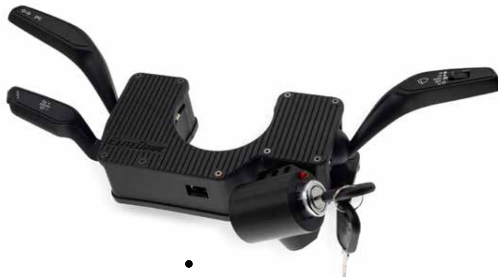
● L版黑洞模块 (外壳采用高精度3D打印工艺)
